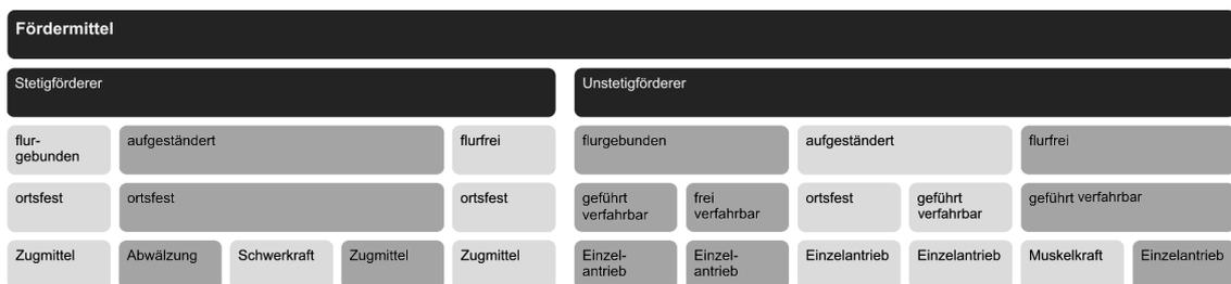
**Abbildung 1.7:** Relevante Fördermittel für die Einordnung Zellularer Transportsysteme, *in Abwandlung von* [tSN07]
